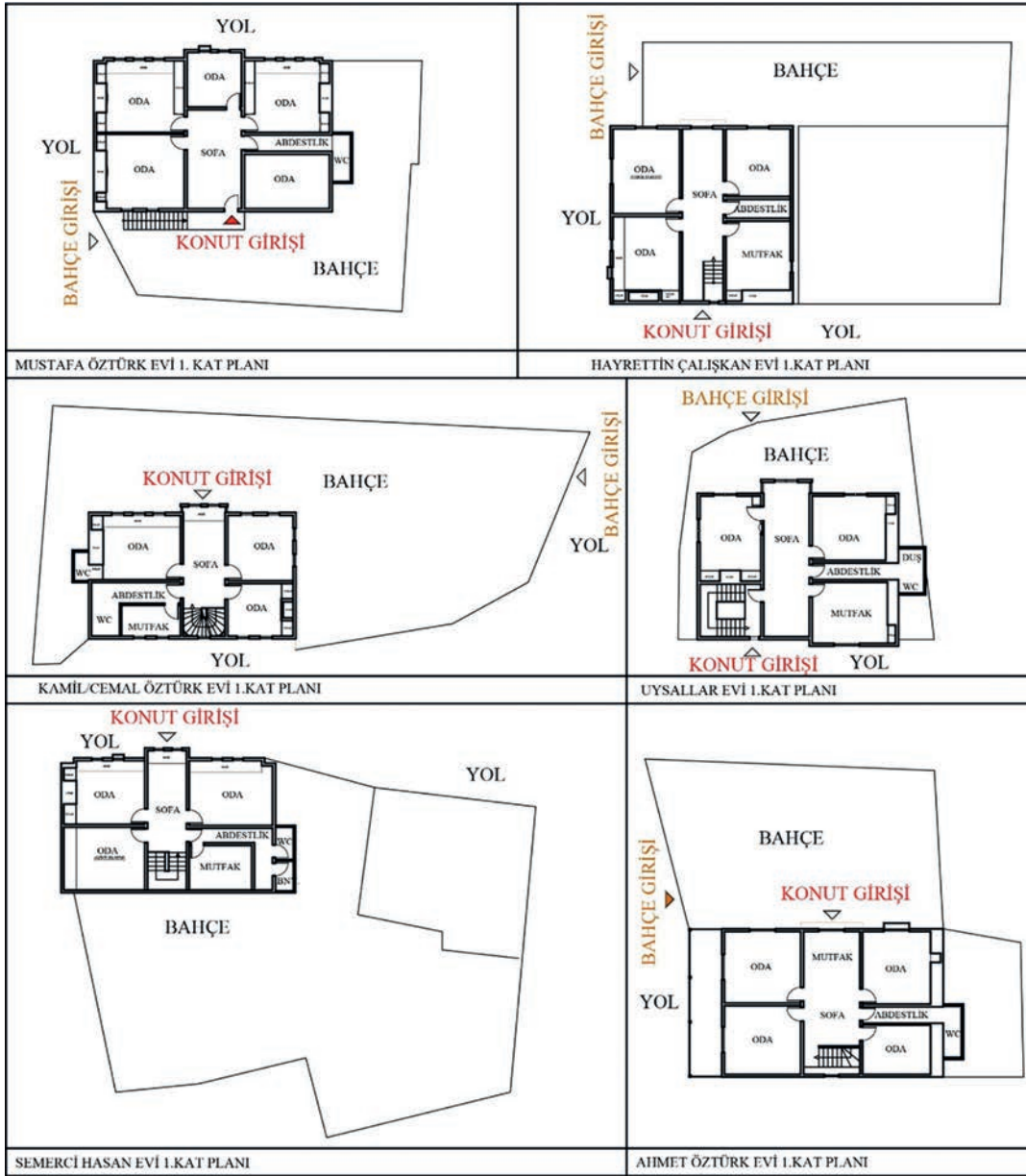
Şekil 13. Laçın geleneksel konutları zemin+ bir katlı yapılara ait plan krokileri / Traditional Laçın houses plan sketches of ground + one storey buildings (Çizim. Öztürk, 2023).
