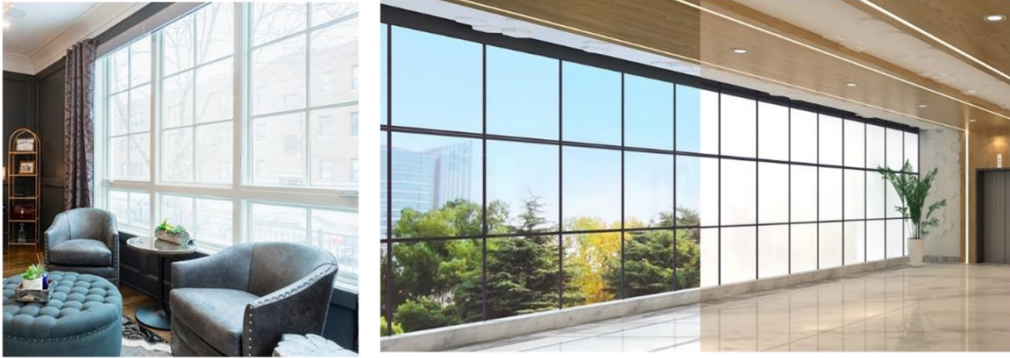
Şekil 7. Termo-kromik camın farklı durumdaki görünüşleri (SE INTERNATIONAL, 2023)
