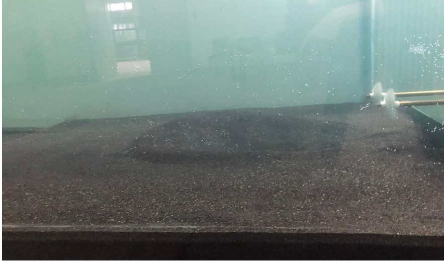
Şekil 7. Pervaneler Dönmeye Başladıktan Sonra Oyulma ve Yığılma Bölgelerinin Oluşumu
