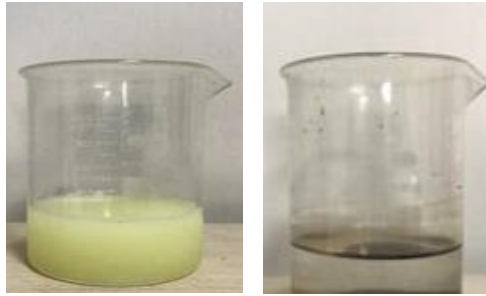
Şekil 2. Taze peynir altı suyunun MNP ile karıştırılarak neodyum mıknatıs etkisi altında bekletilmesi ile arıtımı [24].
