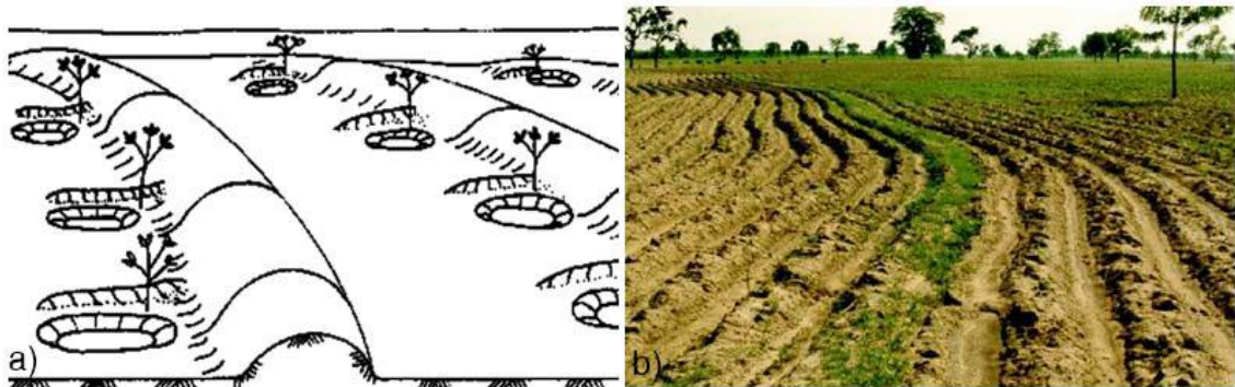
Şekil 6. Şerit havza toprak işleme ya da kontur setleri örnekleri. a) Ağaç dikimi için kontur setleri (Elasha ve ark., 2006), b) Kontur setleri uygulanmış bir alan -Mali (Traorea ve ark., 2004).
