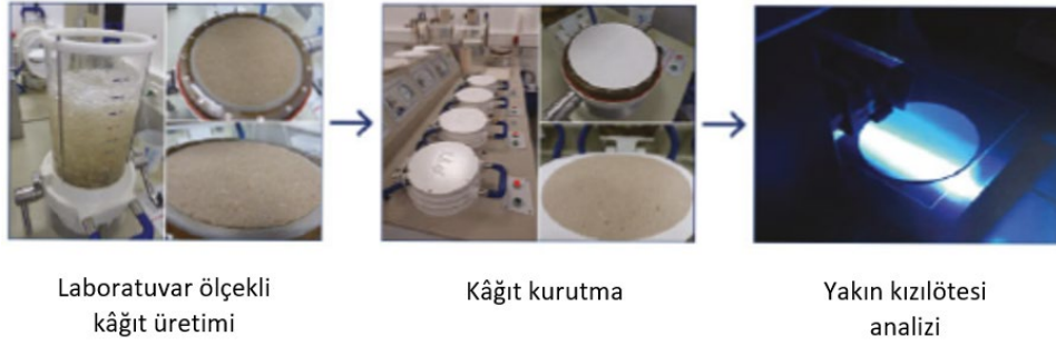
Şekil 4. Yapışkan madde tayini (DIN SPEC 6725).
