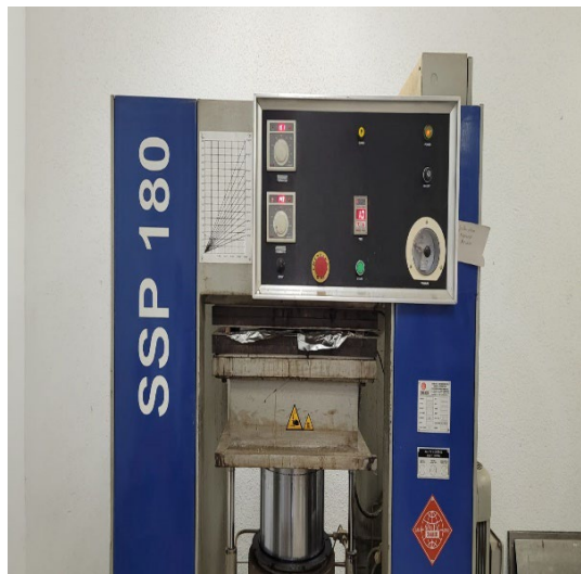
Şekil 1. Levha taslaklarının preslenmesi.
