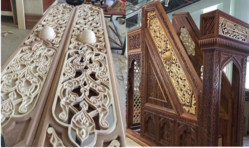
Şekil 14. Ahşap minber korkuluk dişbudak masif malzeme ve vernikli görünümü.
