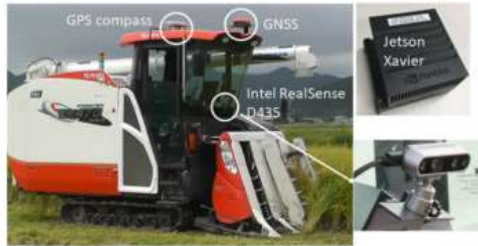
Şekil 10. Otonom biçerdöver üzerindeki sensörlerin yerleşimi (Li ve ark., 2020)
