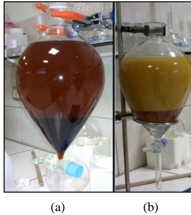
Şekil 5. Atık bitkisel yağın; (a) Gliserin ayrışması, (b) Saf su ile yıkama işlemi
