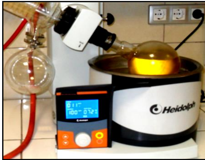
Şekil 2. Kullanılan yağ ve üretilen biyodizelin nemden arındırılması
