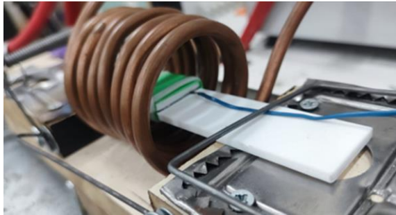
Şekil 10. İndüksiyon ile bağlantıların üretimi.
