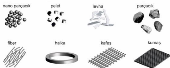
Şekil 8. İletken malzeme geometrileri (Zimmerer vd., 2019).
