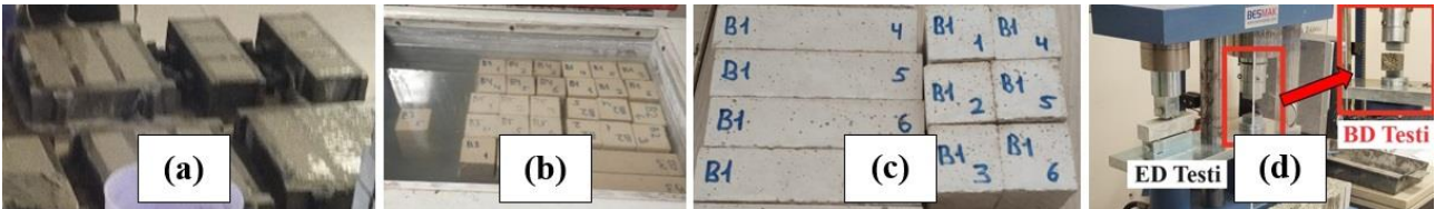
Şekil 1. KYH'lerin kalıplara yerleştirilmesi (a), kür işlemi (b), testler öncesi numuneler (c) ve BD/ED testleri (d)
