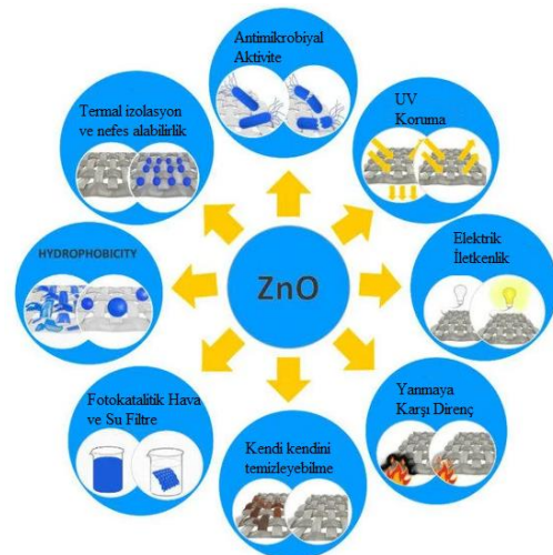
Şekil 2. ZnO'nun tekstil malzemeleri üzerindeki fonksiyonel özelliklerinin şematik gösterimi.
