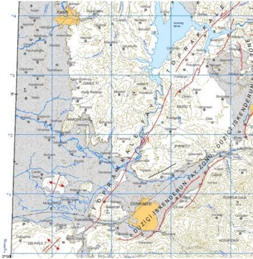
Şekil 10. Sol yönlü doğrultu atımlı Toprakkale fayının ve daha doğudaki İskenderun-Düziçi Fay hattının uzanımını gösterir eşyükseleti haritası (MTA harita arşivinden).
