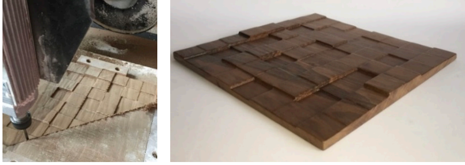
Görsel 28. Satranç tablasının CNC makinesinde şekillendirilme aşaması
