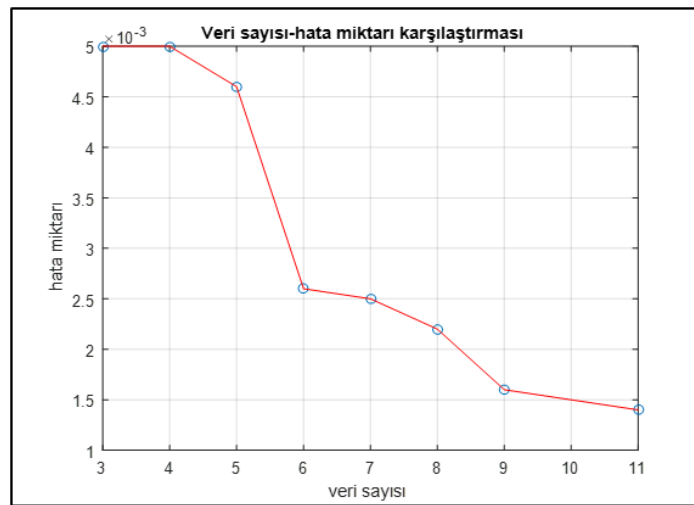
Şekil 13 73 W KFL için 301-600 MHz Frekans Aralığındaki Elektrik Alan Veri Sayısı-Hata Miktarı Karşılaştırılması
