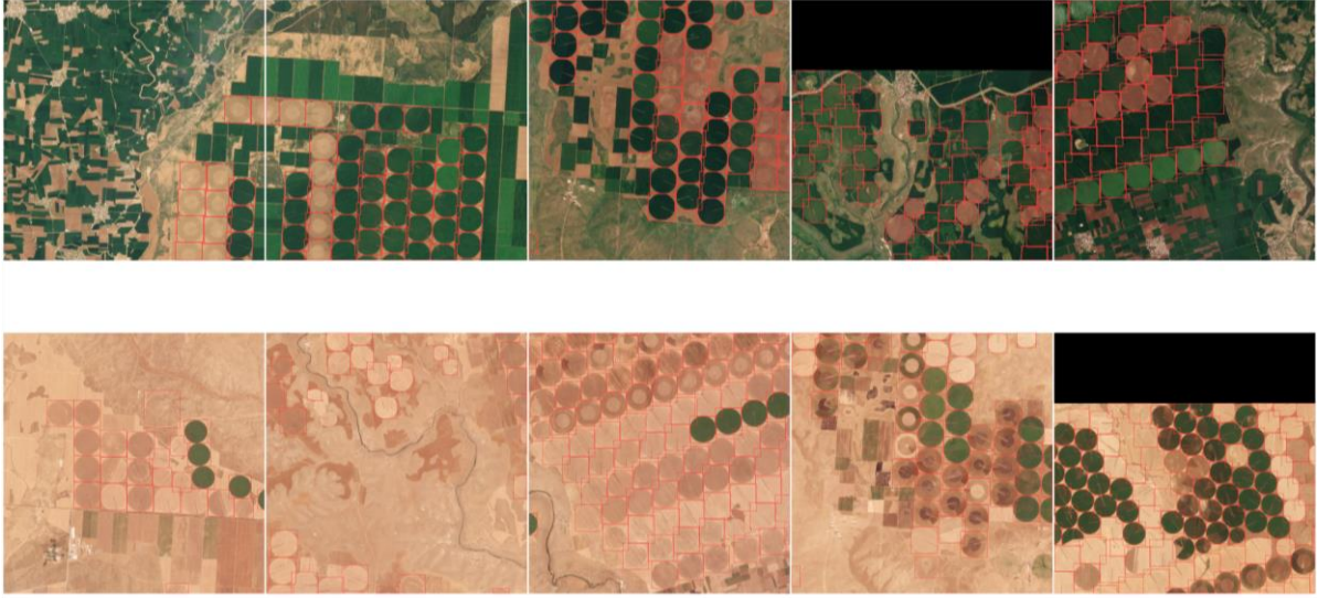
Şekil 2. Yüksek çözünürlüklü PlanetScope görüntülerinde YOLOv9 algoritması ile tahmin edilen dairesel hareketli sulama sistemi alanları
