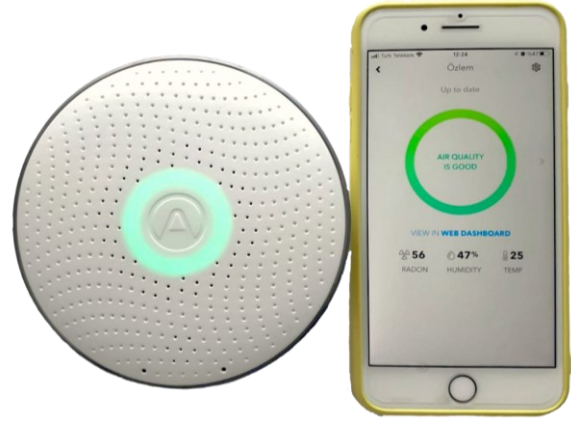
Şekil 2. Wave radon dedektörü ve cep telefonu uygulamasının ekran görüntüsü
