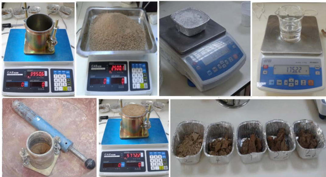
Şekil 3. Standart proktor deneyi aşamaları
