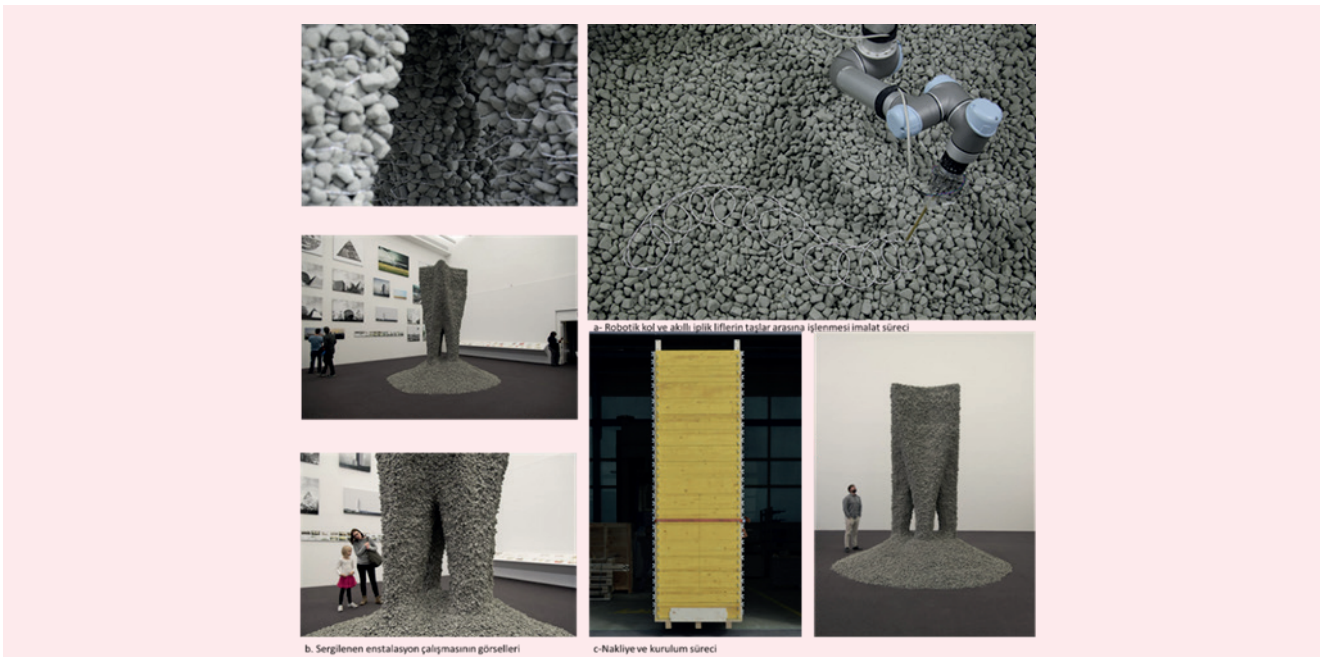
Şekil 19. Rock Printing Projesi (a. Robotik kol desteği ile programlanmış tekstil iplikleri kullanarak taşlar arasında baskı süreci, b. Sergilenen enstasyon çalışmasının görselleri, c. Nakliye ve kurulum süreci) (URL-16, 2024)
