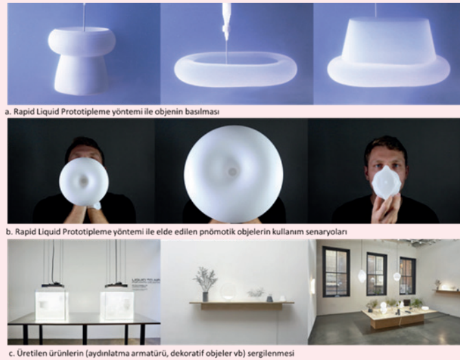
Şekil 26. Liquid to Air: Pneumatic Objects (a.RLP yöntemi ile objenin basılması b. RLP yöntemi ile elde edilen pnömatik objelerin kullanım senaryoları c.Üretilen ürünlerin sergilenmesi) (URL-23, 2024)
