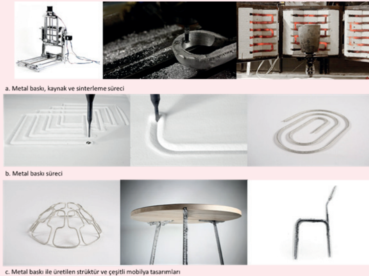
Şekil 27. Liquid Metal Printing (a.Metal baskı, kaynak ve sinterleme süreci b. Metal baskı süreci c. Metal baskı ile üretilen strüktür ve çeşitli mobilya tasarımları) (URL-24, 2024)
