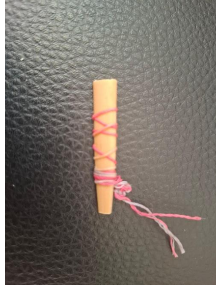
Şekil 21. Şişe geçirmeden önce sarılmış kamış
