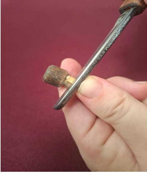
Şekil 20. Yaprak kamışın uçlarının inceltilmesi işlemi
