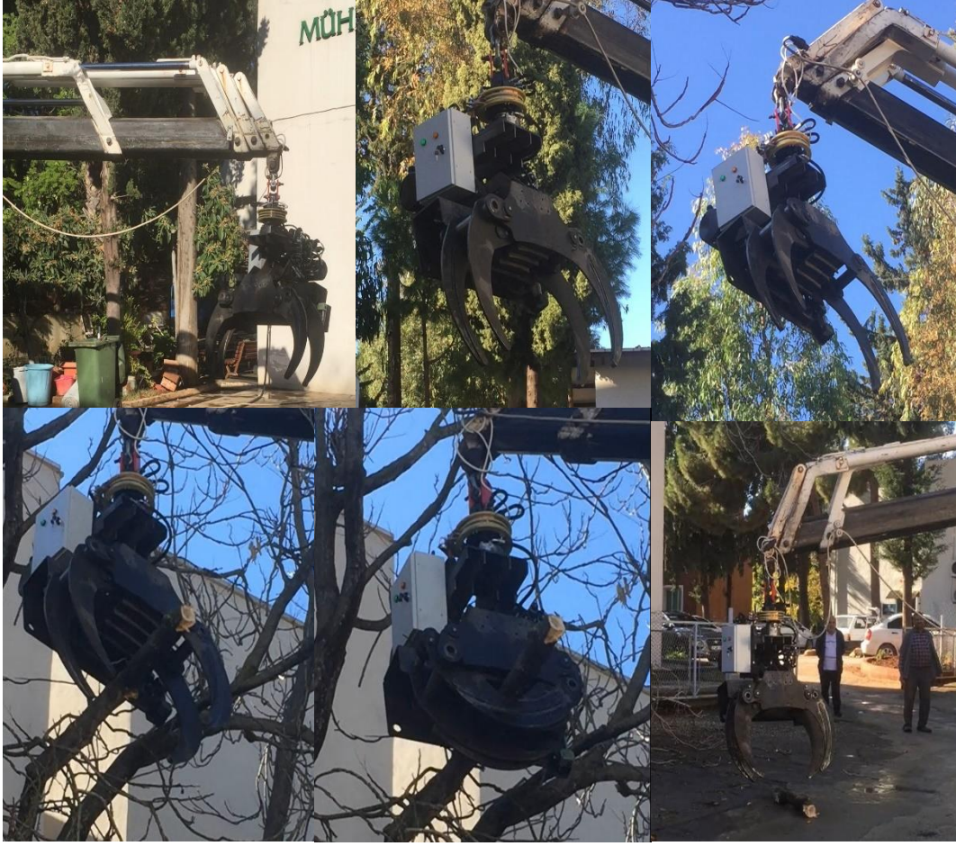
Şekil 12. Bağımsız hareketli budama aparatı fonksiyonellik denemeleri
