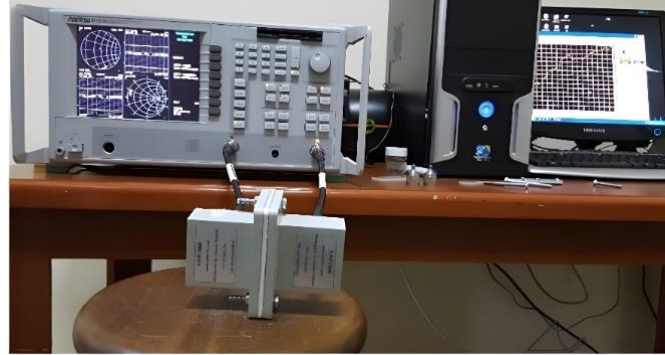
Şekil 3. Örnek S parametre Ölçüm Sistemi
