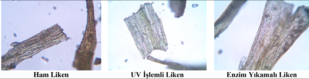
Şekil 4. Ham liken ve yüzey modifikasyonu sonrası likenlerin ışık mikroskobu görüntüleri (x400). Figure 4. Light microscopy images of raw lichen and surface modified lichens (400x).
