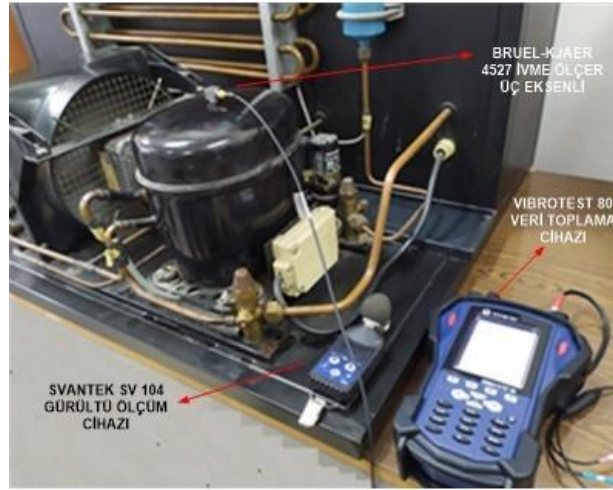
Şekil 6. Titreşim ve gürültü ölçüm işlemi Figure 6. Vibration and noise measurement process
