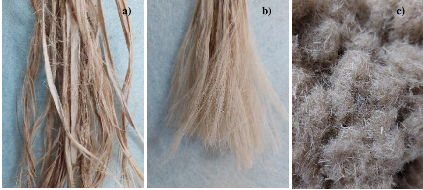
Şekil 1. a) Temin edilen kenevir lifler, b) Taranmış kenevir lifler ve c) Kesilmiş kenevir lifler
