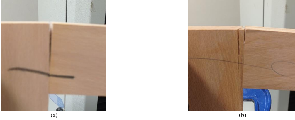
Şekil 9. Testlerde görülen kırılma şekilleri; a) açılma b) liflere dik kırılma
