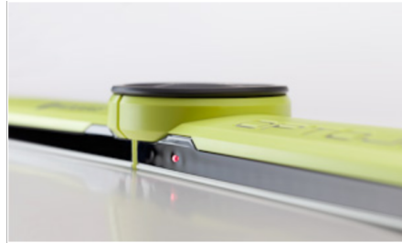
Şekil 1. OptoJump Ölçüm Aleti
