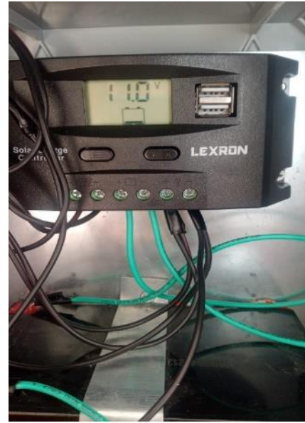
Şekil 7. Monokristal ve polikristal panel akülerinin ilk ölçüm değeri
