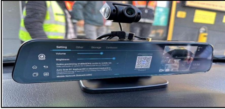
Şekil 9. Araç içi kamera ve gps anteni montajı
