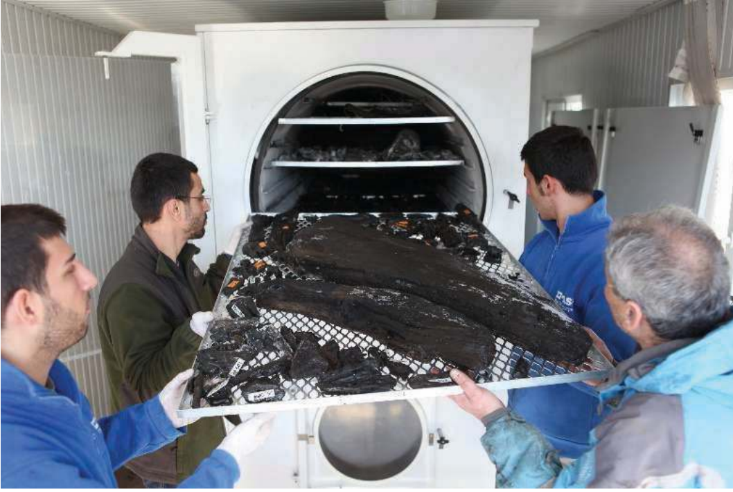
Fig. 7 Çamaltı Burnu 1 Batığı ahşaplarının dondurarak kurutma cihazına yerleştirilmesi.
