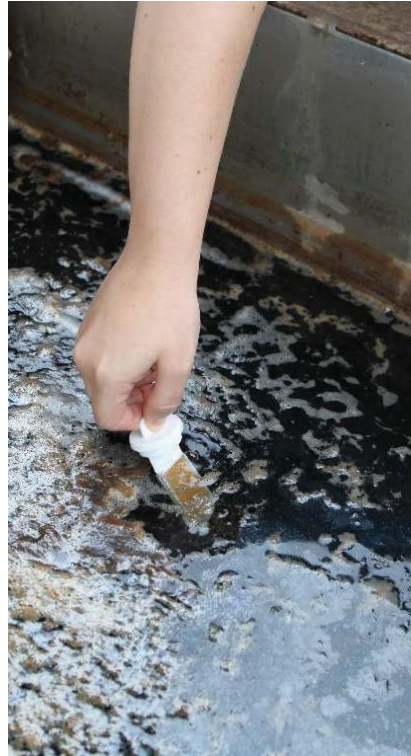
Fig.4 Biyolojik aktivasyonun yođunluđunun tespiti iin dipslide ile yapılan lümler.
