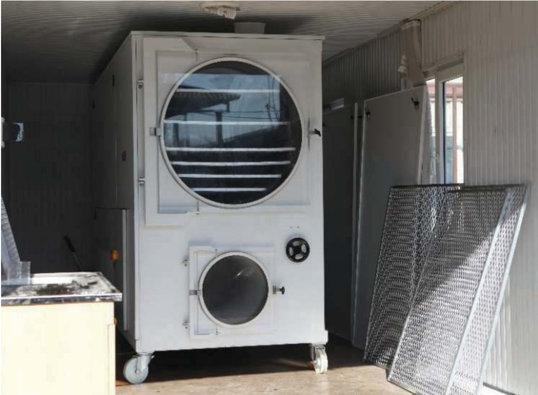
Fig.6 Çamaltı Burnu 1 Batığı ahşaplarının konservasyonunda kullanılan dondurarak kurutma cihazı
