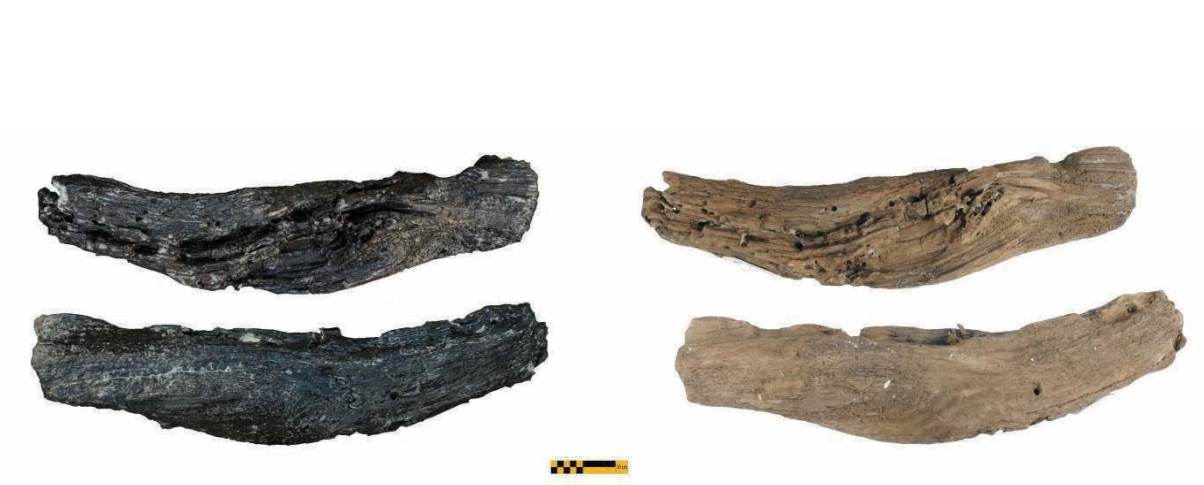
Fig. 10 2 no'lu parçanın konservasyon öncesi (sol) ve sonrası (sağ), ön ve arka görüntüleri.
