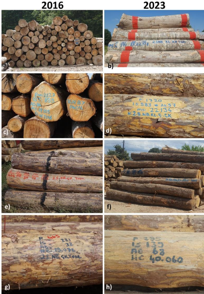
Şekil 9. a) Arapoturağı Deposu 2016 yılı enine kesitlere yazılmış istif bilgileri, b) Arapoturağı Deposu 2023 yılı standartta belirtildiği gibi çekilmiş şeritler ve bilgiler; c) Devecikonak Deposu 2016 yılı enine kesitlere yazılmış istif bilgileri, d) Devecikonak Deposu 2023 yılı istif bilgileri; e) Etili Deposu 2016 yılı otlu zemin ve istif bilgileri, f) Etili Deposu 2023 yılı istif ve bilgilerin yazımı; g) Dallık Deposu istif bilgileri: 2016 yılı, h) Dallık deposu istif bilgileri: 2023 yılı
