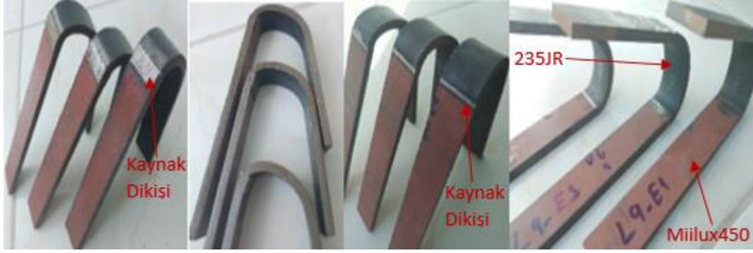
Şekil 6. Eğme testi sonucu eğilen kaynaklı numuneler
