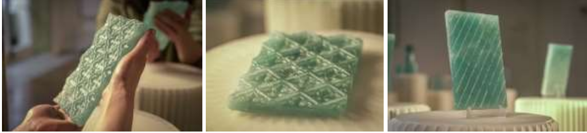
Şekil 13. Midye kabuklarından yapılan biyo-cam cephe karosu (Bahadursingh, 2022)
