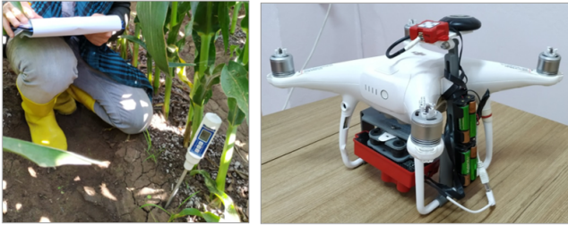
Şekil 2. Toprak Nemi ölçümü (a), DJI Phantom 4 Pro'ya entegre Micasense 3 (b).
