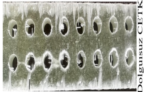
Şekil 6. Dolgusuz ve hibrit dolgulu CETK'lerin delme sonrası deformasyon görüntüleri
