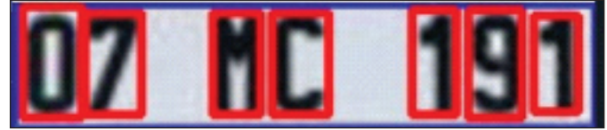
Şekil 6. YOLO algoritması ile karakterleri işaretlenmiş plaka görseli.
