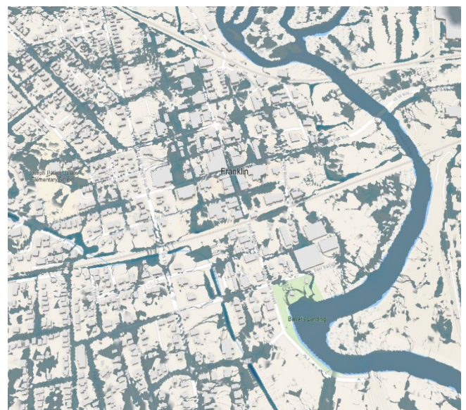
Şekil 7. Taşkın simülasyonu sonucunda oluşan kentsel su baskını.
