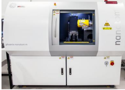
Şekil 12. Mikro bilgisayarlı tomografi Figure 12. Micro computed tomography
