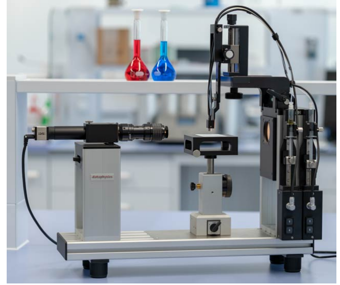
Şekil 1. Temas açısı test cihazı DataPhysics OCA - Series
