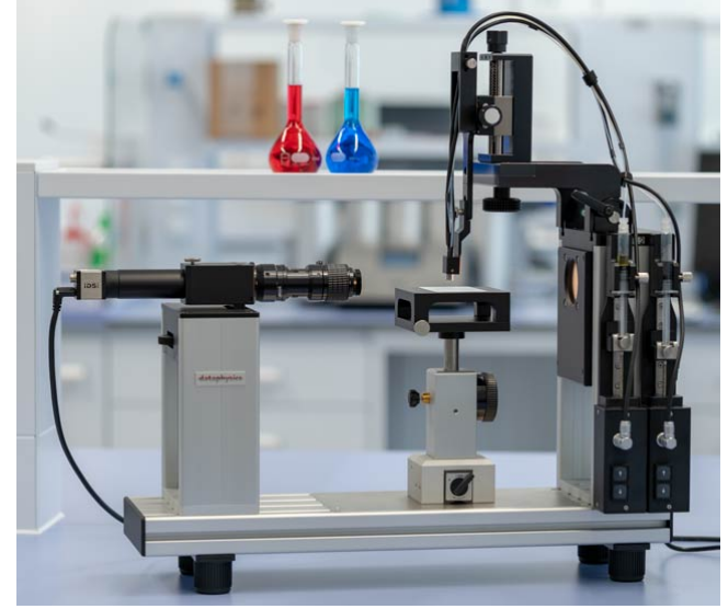
Şekil 1. Temas açısı test cihazı DataPhysics OCA - Series
