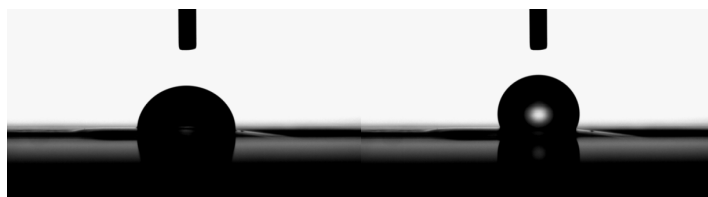
Şekil 3. Zhermack Elite HD ölçü materyalinin 0.138 ve 82.8. saniyelerdeki distile su ile teması
