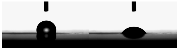
Şekil 2. Spirias ölçü materyalinin 0.138 ve 82.8. saniyelerdeki distile su ile teması
