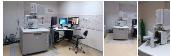
Şekil 12. SEM-EDX deneyi için kullanılan Quanta Feg 250 makinesi (2024)
