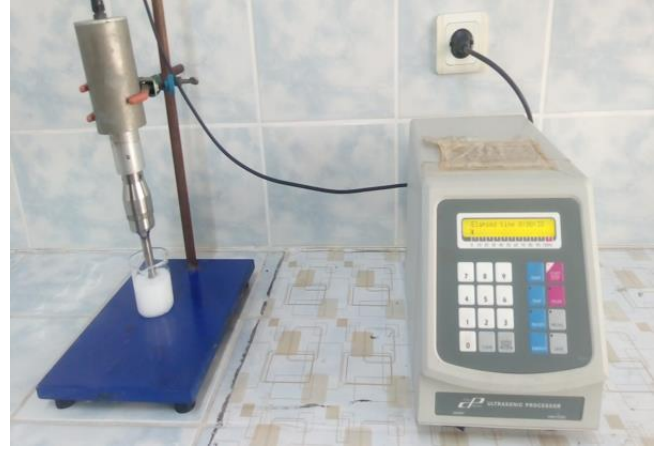
Şekil 4. Atık yağın ultrasonik cihazla emülsifikasyonu
