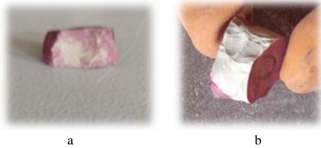
Şekil 3. a) % 3 Manyezitli kompozisyon, b) Standart kompozisyon.
