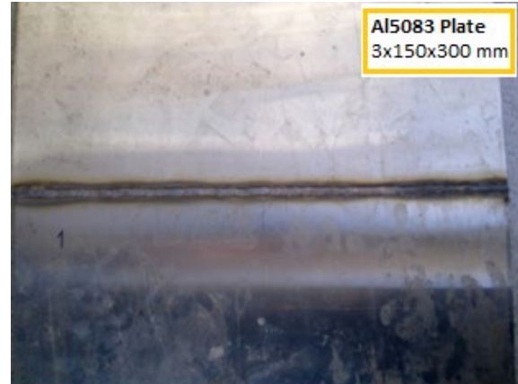
Şekil 3. Deney numunelerinin ölçüsü ve kaynak yapılış şekli
