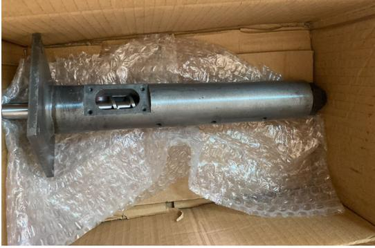
Şekil 2. Ekstrüderde kullanılan vida, nozul ve kovan sistemi
