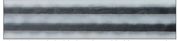
Şekil 3. T1 kalınlık değerine sahip bir numunenin karbon fiber takviyeli nylon ve Nylon White malzemelerinin nihai yerleşiminin görünümü.
