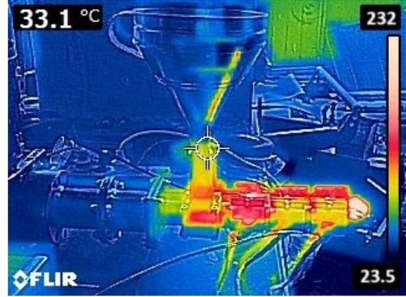
Şekil 8. Termal kamera ile görüntülenmiş kovanın sıcaklık dağılımı
