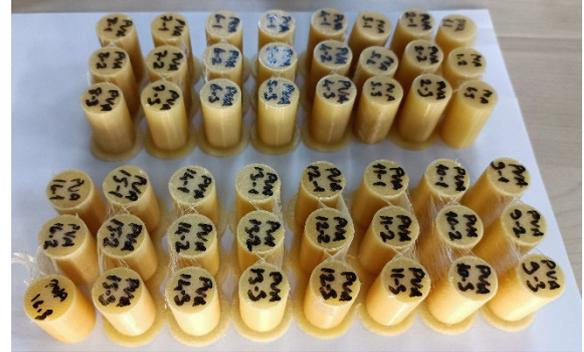
**Şekil 3.** EBM basma numuneleri
