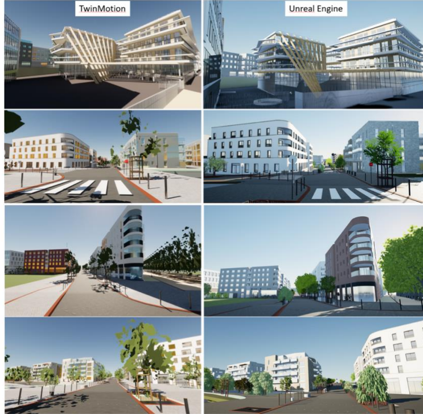
Şekil 5 Sol: TwinMotion projesi. Sağda: Unreal Engine sahnesi. Unreal Engine dokusu ve aydınlatması, daha karikatürize olan TwinMotion sahnesinden daha gerçekçidir (Belaroussi, Dai, González, & Gutiérrez, 2023, s. 20).
