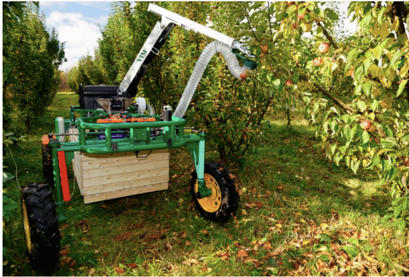
Şekil 5. Meyve toplama robotu (Kutyrev vd., 2022)
