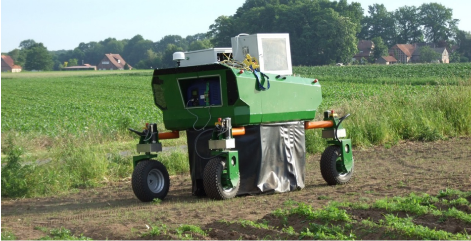
Şekil 4. BoniRob tarım robotu (Bangert vd., 2013)
