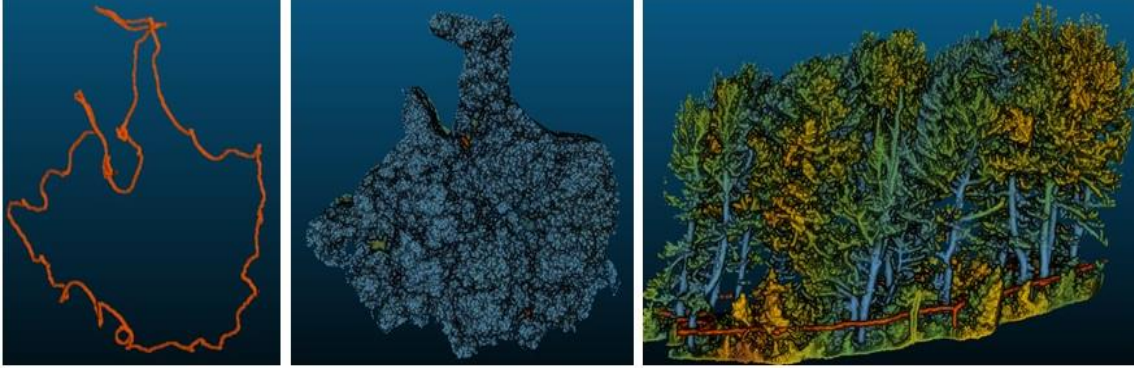
Şekil 4. Lidarla taramada kullanılan rota ile örnek alan içerisine giren ağaçların üstten ve yandan görünümü.
