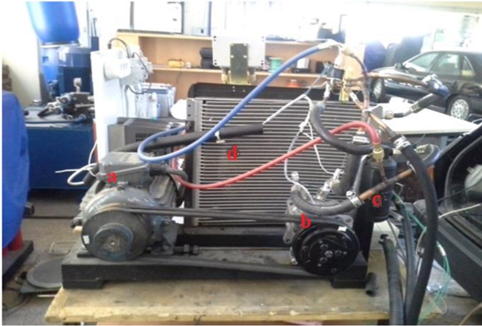
Şekil 5. Deney düzeneğinin arkadan görünüşü a. Elektrik motoru, b. Kompresör, c. Kurutucu, d. Kondansör
