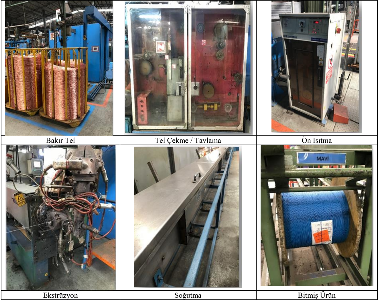
řekil 2. TANDEM izolasyon hattı görünümü (TANDEM insulation line view)
