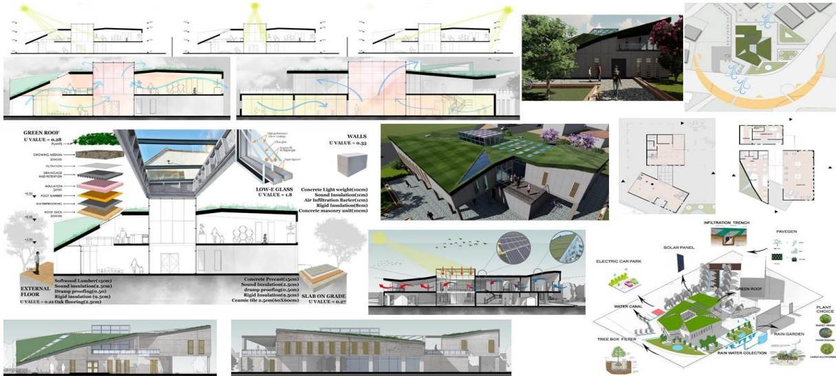
Şekil 5: Grup-4 tasarım önerisi, kapalı/açık galeri, kütle yönelimi, yaz/kış galeri stratejisi, doğal ışık, doğal havalandırma, yeşil çatı tasarımı ve gölgeleme elemanlarını içeren nihai kütle stratejisini sunmaktadır.
