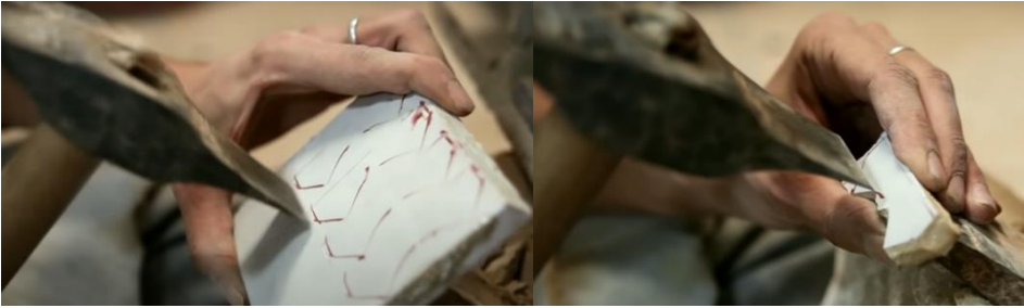
Şekil 16: Çizilen desenlerin minkaş yardımıyla birbirinden ayrılması ve parçalara son hali verilmesi. 85
