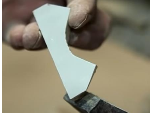
Şekil 17: Her bir zellic parçasının kenarlarının pürüzsüzleştirilip dizime hazır hale getirilmesi. 87
