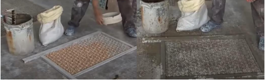
Şekil 20: Dizilen parçaların üzerinin yapıştırıcı karışım hazırlığı. 92
