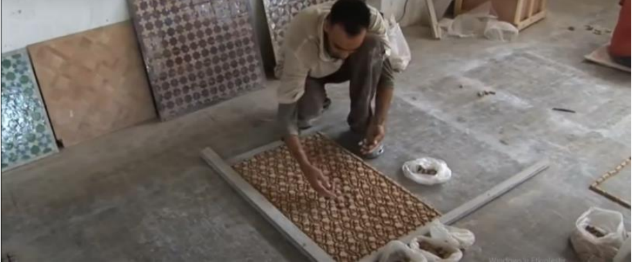
Şekil 19: Kompozisyona uygun bir kasnak içinde ters bir şekilde parçaların dizilmesi. 91
