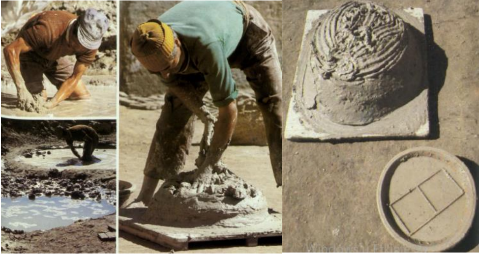
Şekil 10: Zellic hamurunun hazırlanması (sol) 66 ve yığın halinde bir miktar kuruması için güneşe bırakılması (sağ) 67
