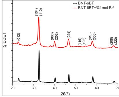
**Şekil 1.** Hidrotermal yöntem ile 12M NaOH çözeltisi ile üretilen BNT-6BT ve BNT-6BT+%1 mol B<sup>3+</sup> tozlarının XRD spektrumları (XRD spectra of BNT-6BT and BNT-6BT+1 mol % B<sup>3+</sup> powders synthesized via hydrothermal method with 12M NaOH solution)
