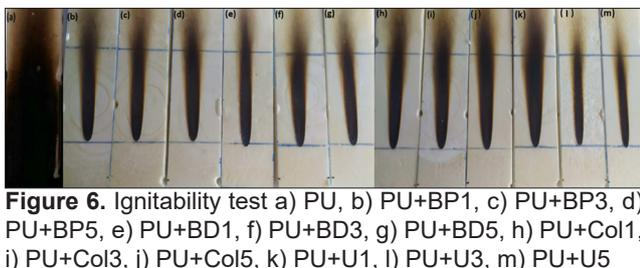
**Figure 6.** Ignitability test a) PU, b) PU+BP1, c) PU+BP3, d) PU+BP5, e) PU+BD1, f) PU+BD3, g) PU+BD5, h) PU+Col1, i) PU+Col3, j) PU+Col5, k) PU+U1, l) PU+U3, m) PU+U5
