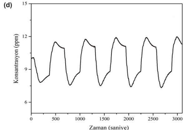
**Şekil 6.** Farklı akış hızlarında elektrotların dögüsel performans analiz sonuçları. 4 ml/dk akış hızı için a) akım-potansiyel-zaman ve b) konsantrasyon-zaman grafiği, 10 ml/dk akış hızı için c) akım-potansiyel-zaman ve d) konsantrasyon-zaman grafiği (Cyclic performance of analysis results of electrodes at different flow rates. a) Current-voltage-time profiles and b) concentration-time profiles for 4 ml/min, c) current-voltage-time profiles and d) concentration-time profiles for 10 ml/min)
