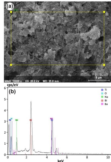
**Şekil 3.** 12M NaOH çözeltisi ile üretilen BNT-6BT+ %1 mol B<sup>3+</sup> tozunun a) 10.000X SEM görüntüsü (Ölçek çubuğu: 5 µm) ve b) EDX spektrumu. (a) 10.000X SEM image (Scale bar: 5 µm) and b) EDX spectrum of BNT-6BT+1 mol % B<sup>3+</sup> powders synthesized via hydrothermal method with 12M NaOH solution)
