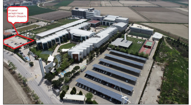
Şekil 8. Büyük Misafir Otoparkına kurulacak 231 kW'lık PV sistemi yeri
