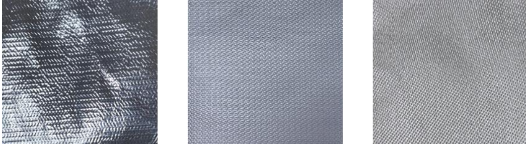
Şekil 1. Sırayla alüminyum folyo kaplı cam elyaf kumaş, silikon kaplı cam elyaf kumaş, vermikülit kaplı silika kumaş
