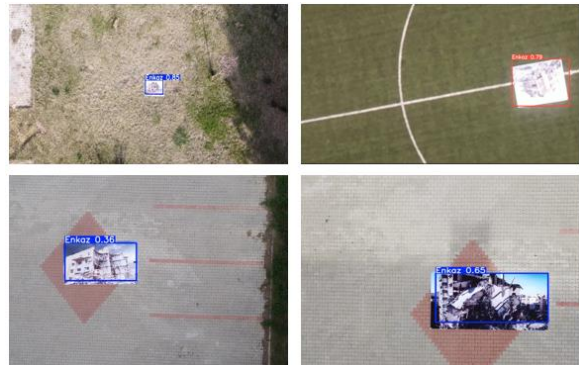
Şekil 12. Sahada kurulan test ortamında YOLOv8 modelinin enkaz tespiti
