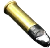
Şekil 15. Mermi sürememe hatası sonucu mühimmat
