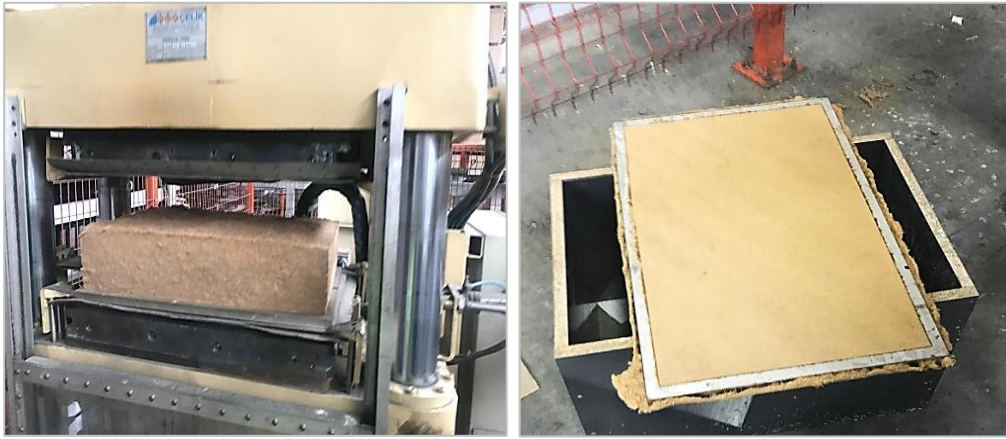
Şekil 1. Lif taslağının preslenmesi
