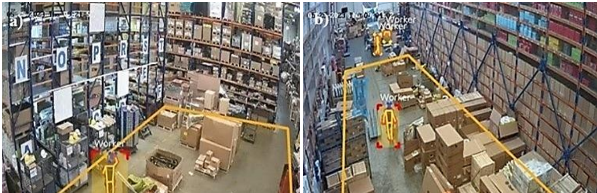
Şekil 6. Baret kullanımının yapay zekâ kullanılarak kontrolünün yapılması (Akman, 2024). a) Depo çalışanlarının baret kullanımlarını geniş alanda intenseye teknolojisi ile izlenme görüntüsü. b) Depo çalışanlarının baret kullanımlarını izleme görüntüsü.
