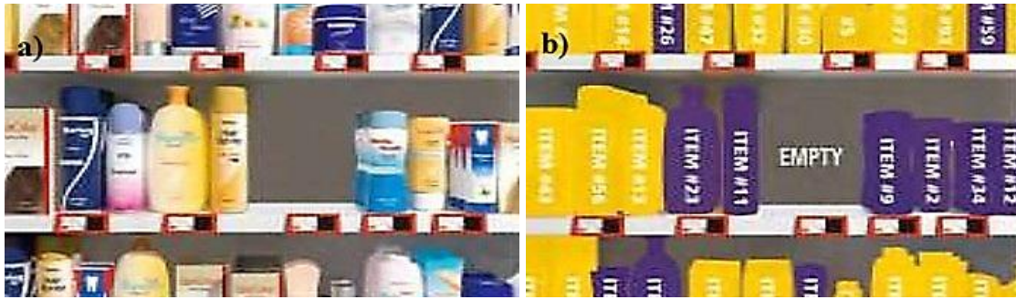
Şekil 14. Bir firmanın Qopius bilgisayarla görme örneği (Aylak vd., 2021). a) Bir firmaya ait akıllı telefon ile çekilen perakende rafın görüntüsü. b) Qopius ile görselleştirilmiş raf görüntüsü.
