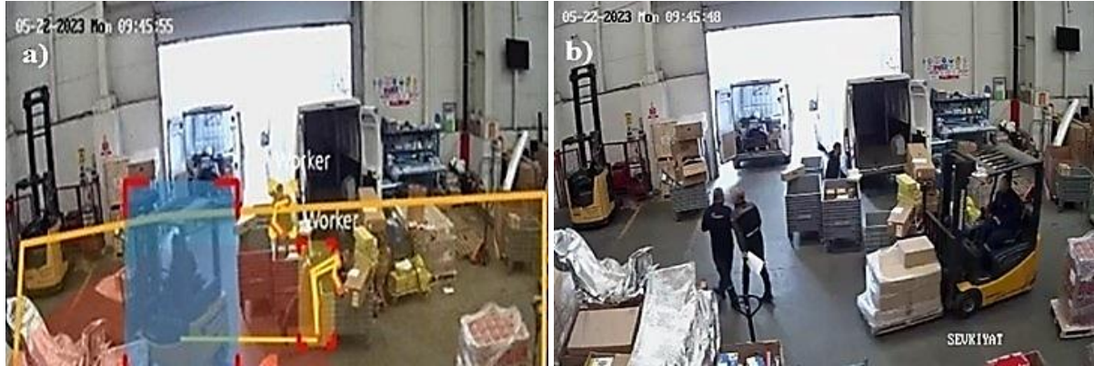
Şekil 7. Dinamik sınırlı alan gösterimi (Akman, 2024). (Dinamik Sınırlı Alan: Çalışma ortamlarında belirli bölgelerdeki hareketli bir yapıya sahip olan veya aktif olarak kullanılan sınırlandırılmış alanları belirtmektedir) a) İşyerinde intenseye teknolojisi ile dinamik sınırlı alan gösterimi. b) İşyerindeki dağınık ve düzensiz çalışma alanlarından bir görüntü.
