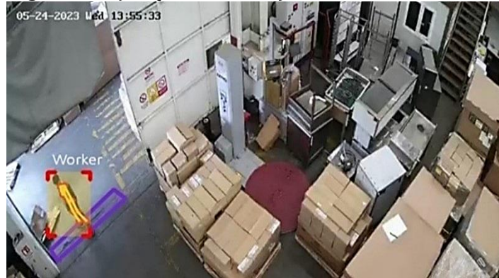
Şekil 8. İşyerinde intenseye teknolojisi ile statik sınırlı alan gösterimi (Akman, 2024). (Statik Sınırlı Alan: Çalışma ortamlarında belirli bölgelerdeki durgun bir yapıya sahip olan veya pasif olarak kullanılan sınırlandırılmış alanları belirtmektedir)
