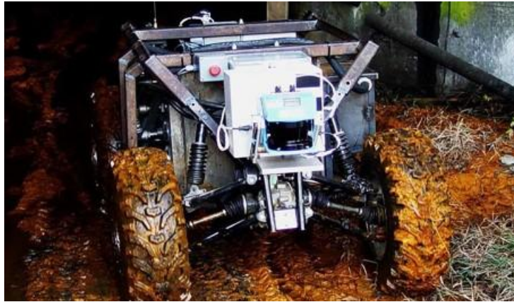
Şekil 18. Maden Sahalarını Haritalama Özelliğine Sahip Groundhog Adlı Otonom Araç (Baker vd., 2004)
