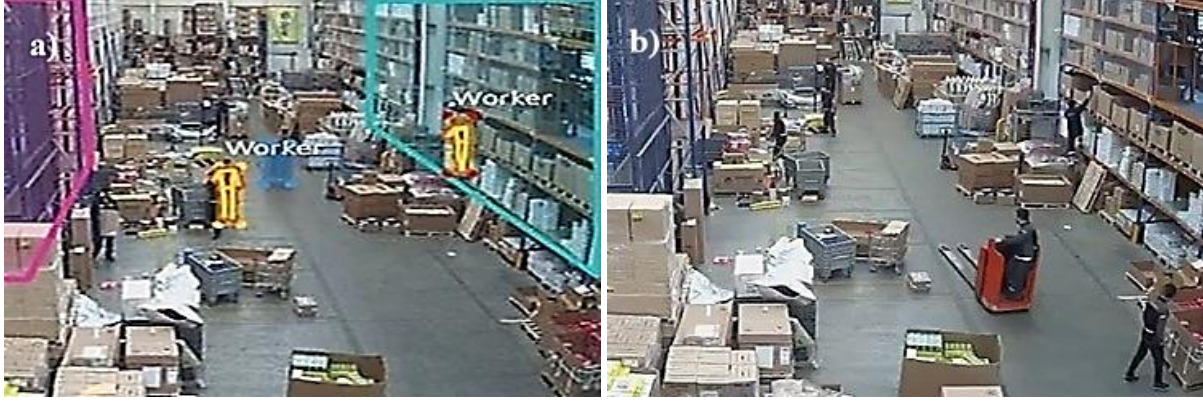
Şekil 5. Depolarda Yapay Zekâ destekli intenseye teknolojisinin kullanımı (Akman, 2024). a) Çalışanların KKD'leri doğru bir şekilde kullanıp kullanmadıklarının intenseye teknolojisi ile izlenme görüntüsü. b) Çalışanların günlük çalışma ortamlarından bir görüntü.
